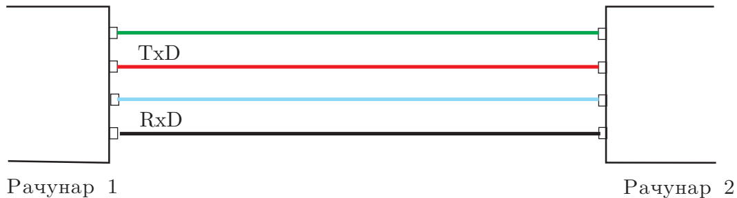
Слика 69: Редни пренос података са раздвојеним каналима за пријем и слање.
